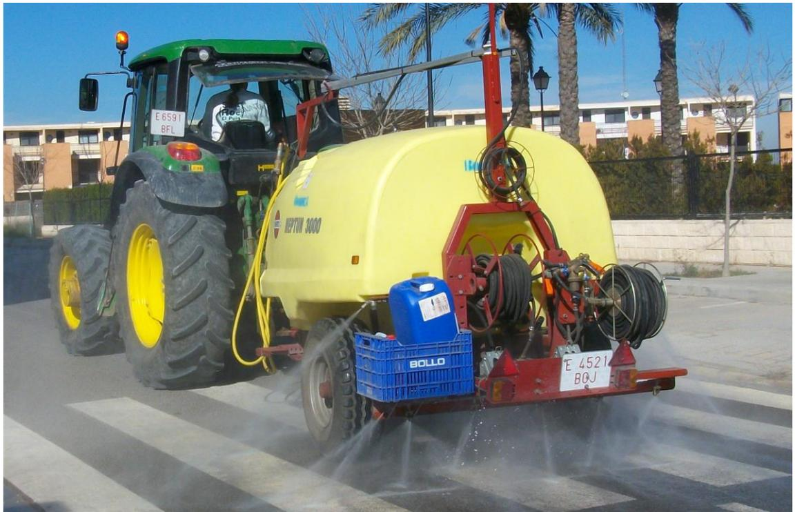
**Observaciones:** Equipado con dos puestos de manguera y pistolas de presión, bomba de pistones, mando eléctrico con electroválvulas.
